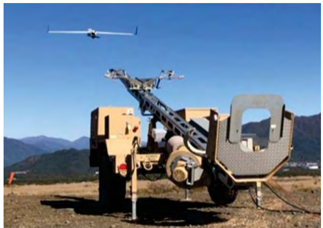
発射装置から飛び立つスキャンイーグル。翼幅は 3.1 m。（防衛省の資料から）
