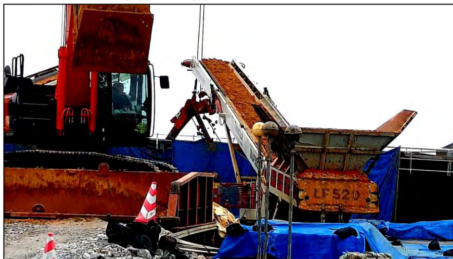
塩川港の様子。ダンプが運んできた土砂(この日は赤土)は、ベルトコンベアで船に積み込まれる
