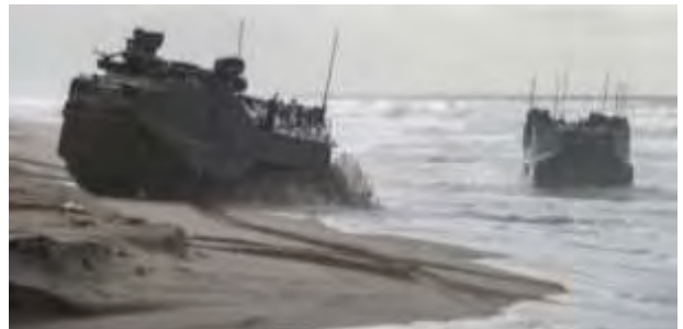
水陸機動団の水陸戦闘車 AAV7 は鋼鉄の塊。1 車両に乗員 3 名、兵員 25 名又は 4.5 t の貨物を載せ、水面を自転車と同じ速度で浮上航行できる。上陸後はそのまま素早く侵攻に。
