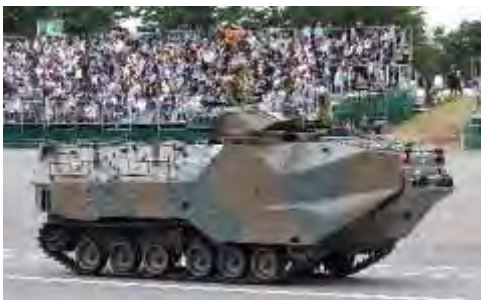
水陸機動団の水陸戦闘車 AAV7 は鋼鉄の塊。1 車両に乗員 3 名、兵員 25 名又は 4.5 t の貨物を載せ、水面を自転車と同じ速度で浮上航行できる。上陸後はそのまま素早く侵攻に。
